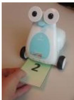
Figure 14 : passage d'une carte sous le robot pour la scanner
