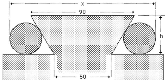
Quelle doit être la cote x de vérification ? (au 1/10e de mm). Calculer la cote h.
